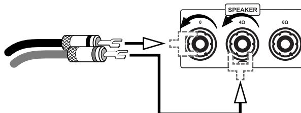
En l'absence de cosse, retirez l'isolant de chaque extrémité du câble sur une longueur d'un cm environ. Torsadez le câble dénudé, pour éviter les court-circuits, desserrez la molette de fixation en la tournant dans le sens antihoraire et insérez l'extrémité du câble dans le perçage dégagé du bornier. Serrez maintenant le câble en faisant tourner la molette de serrage dans le sens horaire. Contrôlez le serrage correct du câble.
