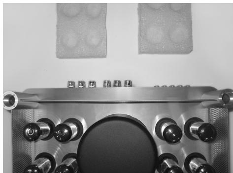
Replacez le rembourrage à son emplacement d'origine avant tout transport de l'appareil.
