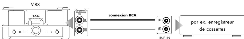
Reliez cette sortie de signal par une paire de câbles RCA, à l'entrée du signal (« LINE IN », « TAPE IN » ou « REC IN ») de l'appareil d'enregistrement.
