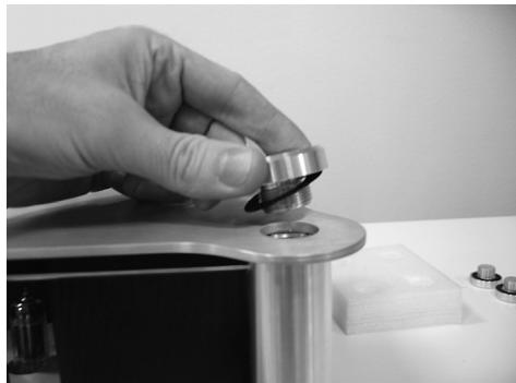
Avant la mise en service, le rembourrage en mousse, visible à présent sous le couvercle de l'appareil, doit avoir été retiré. Sortez le rembourrage, et conservez-le au mieux dans l'emballage d'origine.
