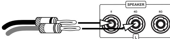
Si on utilise des câbles avec cosses, il faudra desserrer la molette de fixation en la tournant dans le sens antihoraire, insérer la cosse sous la molette et resserrer celle-ci en la tournant dans le sens horaire. Pour éviter tout dommage, assurez-vous que le branchement est bien serré et qu'aucune partie métallique dénudée de la cosse ne soit en contact avec la paroi arrière ou une autre borne de raccordement.
