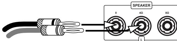
Sollen Kabelschuhe verwendet werden, muss an jeder Klemme der Schraubkopf im Gegenuhrzeigersinn gelöst, der Kabelschuh daruntergeschoben und die Schraubkappe im Uhrzeigersinn festgedreht werden. Stellen Sie zur Vermeidung von Schäden sicher, dass der Anschluss fest sitzt und kein blankes Metall von den Kabelschuhen die Rückwand oder einen anderen Anschluss berührt.
